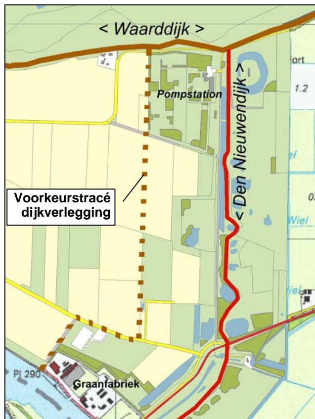
Figuur 3: Voorkeustracé voor de dijkverlegging.
