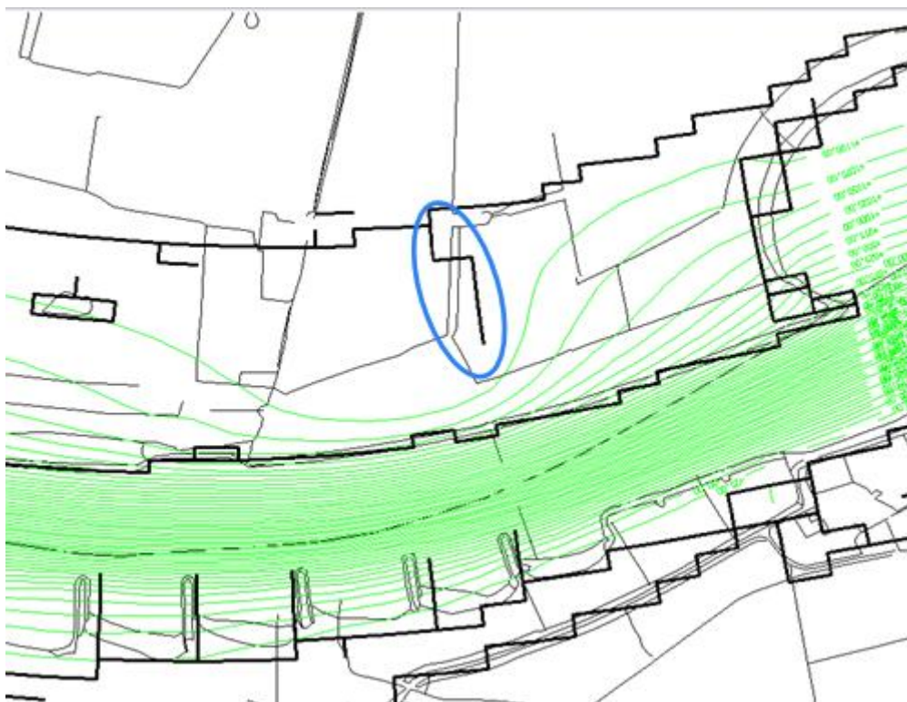
Figuur 12 Stroombanen bij lagere afvoeren rondom de ophoging t.b.v. de bedekking van de gasleiding benedenstrooms van het Ei van Thijsse in Doorwerth
