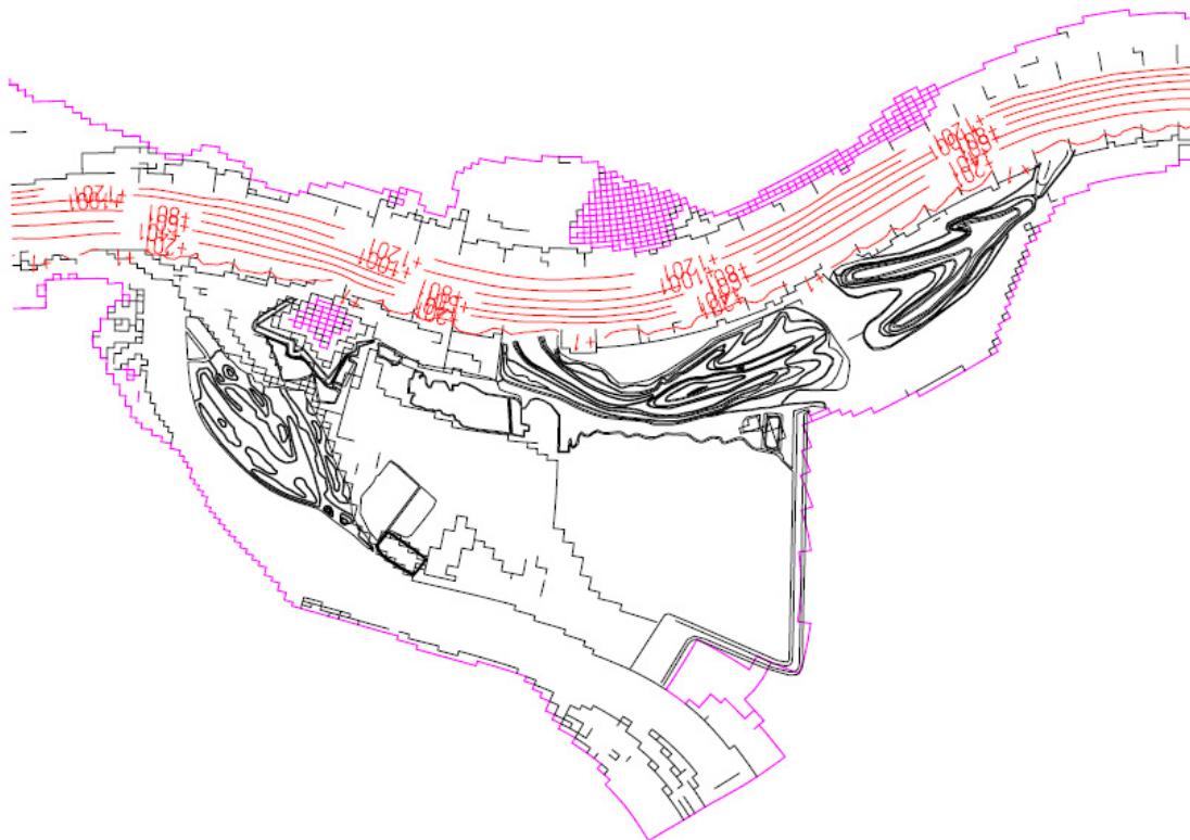
Figuur A.5: Afvoerlijnen ( \text{m}^3/\text{s} ) voor het VKA bij een afvoer van 2.000 \text{ m}^3/\text{s}
