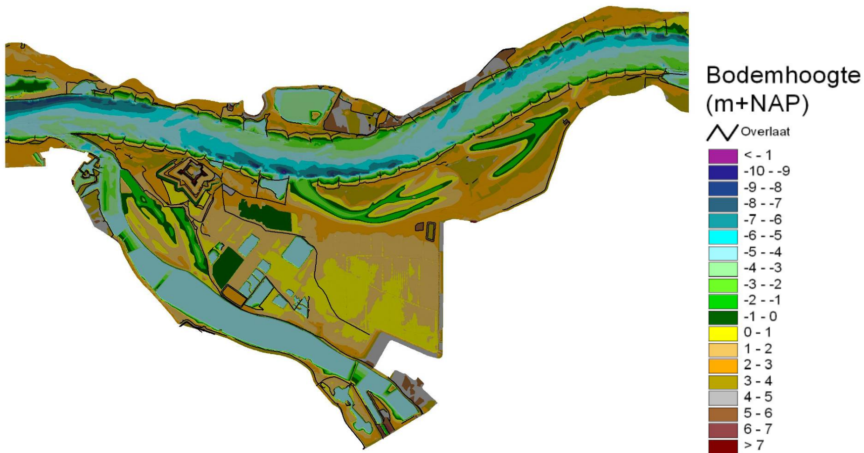
Figuur 3.2: Bodemhoogtes en overlaten VKA (op basis van bodemhoogte- en overlatenbestand uit Baseline)
