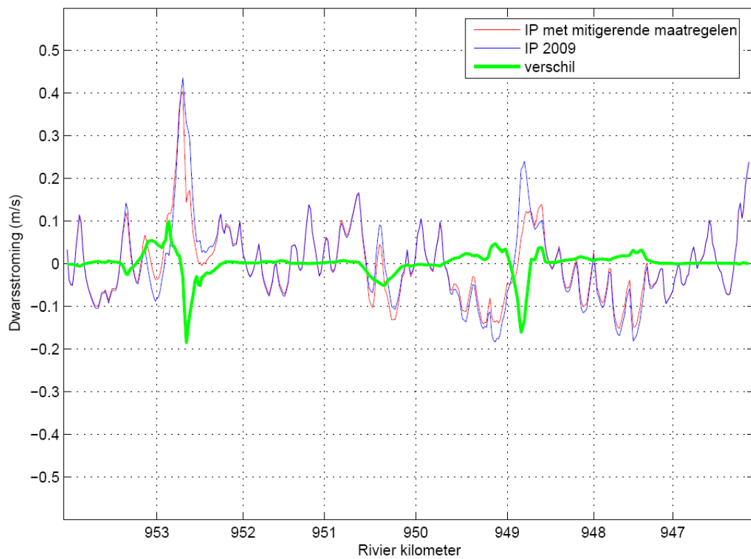
Figuur 3.18: dwarsstroming bij een afvoer van 8.000 m 3 /s voor het IP met maatregelen en IP 2009
