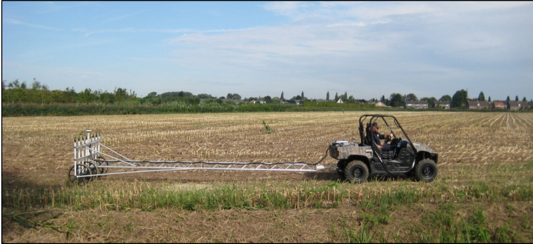
Afb.2 - Multisensorsysteem door een voertuig voortgetrokken.
